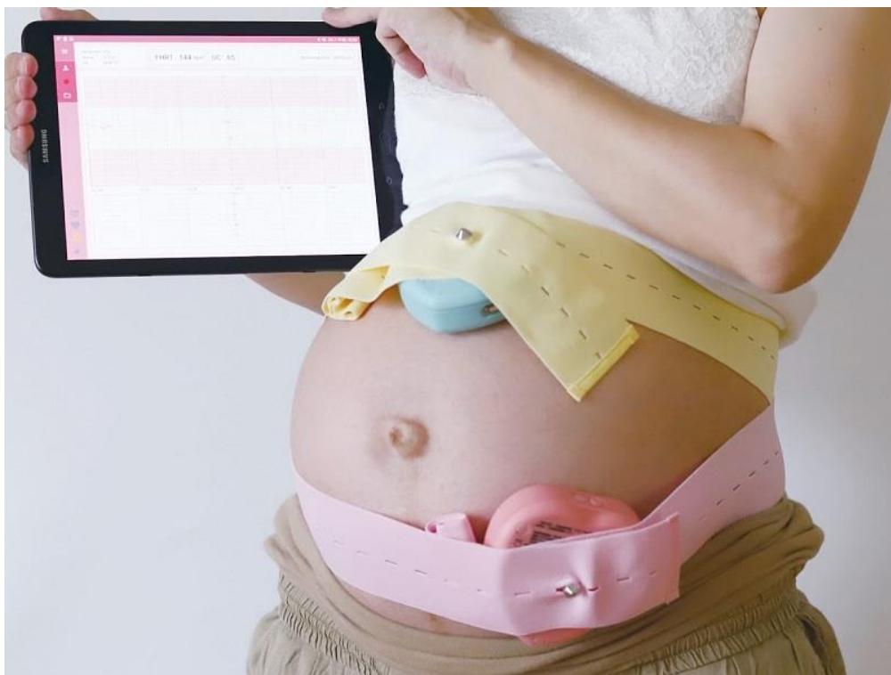
iCTG の利用イメージ（下のピンクのトランスデューサが胎児心拍検出、上のブルーが子宮収縮測定）
